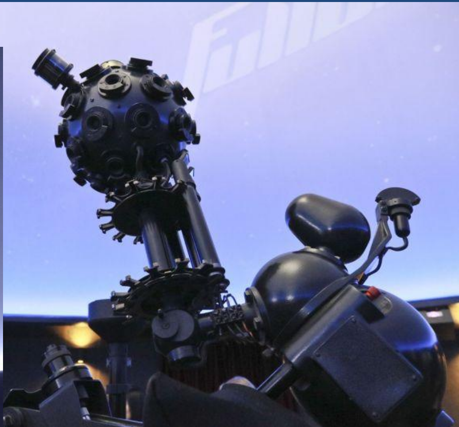
Оптико-механический проектор звездного неба аппарат «Малый Цейс»
